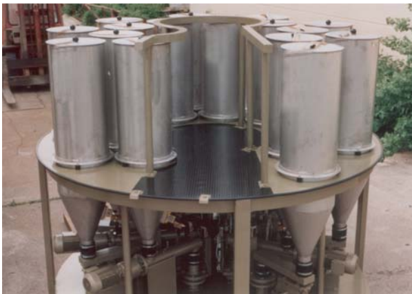
Abb. 1: Mikro-Dosieranlage für 16 Komponenten
